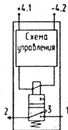
Рисунок 20 – Схема управления ЭМПК АДЮИ453644.005 (007,008)
